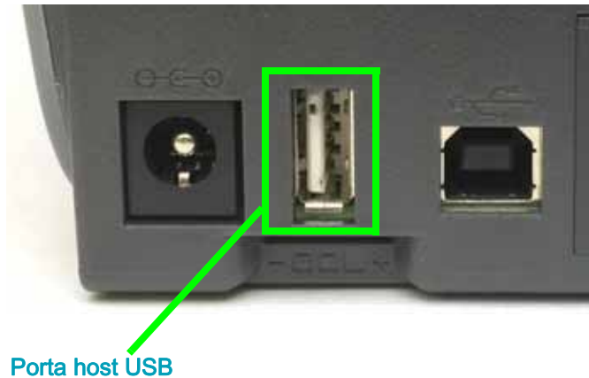
Figura 1 • Posizione della porta host USB
