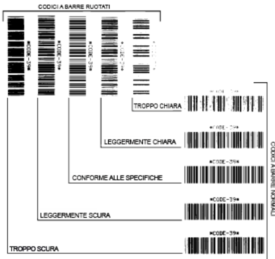
Figura 3 • Confronto dell'intensità del codice a barre
