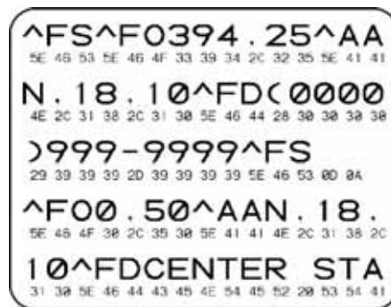
Figura 4 • Etichetta di prova del test di diagnostica delle comunicazioni
